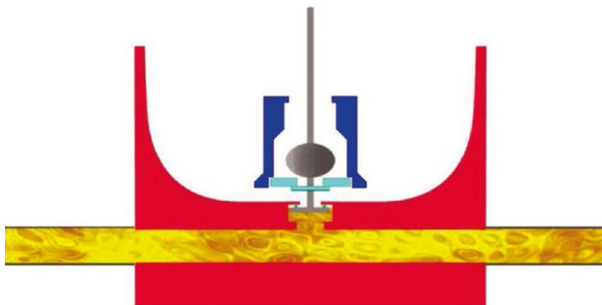
Wird der Stab in der Mitte berührt, fliesst Milch aus dem Leitungssystem nach. Der Pegel im Cup wird durch einen Schwimmer reguliert. (Grafik: zVg)
